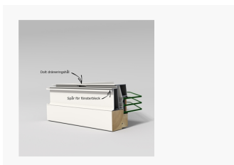
Montering av fönsterbleck LF11283 Royal. Dräneringshålen sitter undertill. Fönsterblecket monteras i det inre spåret, innanför dräneringshålet.
